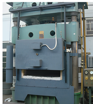
图 4 哈尔滨工业大学研制的 5000 kN 超塑成形设备 [8]
