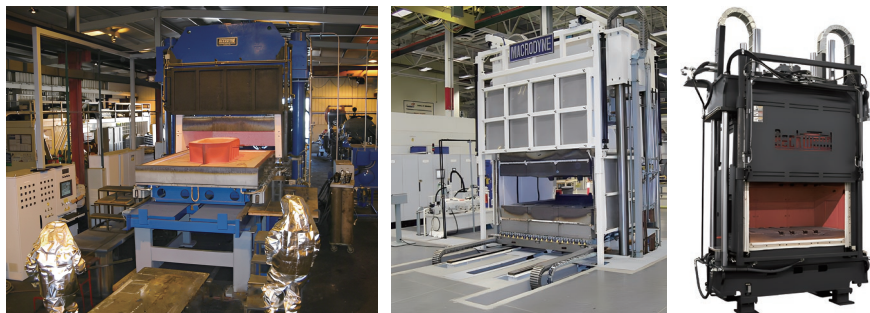
图 3 美国企业制造的超塑成形设备
